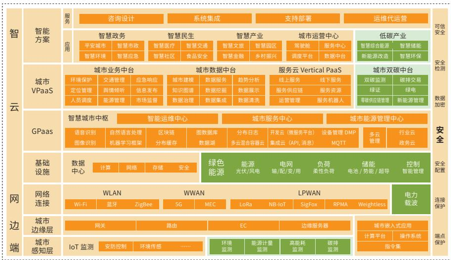
图 3-3 技术实施层技术架构图
